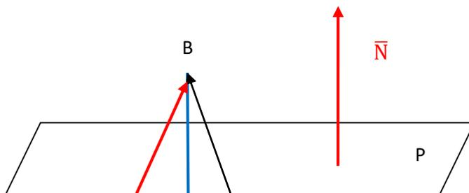
De la figura se observa que la distancia del punto B al plano es igual al módulo de la proyección del vector  $\bar{b} - \bar{a}$  en la dirección del vector  $\bar{N}$ . Esta distancia es igual al valor absoluto de la **componente escalar de  $\bar{b} - \bar{a}$  en la dirección de  $\bar{N}$** , es decir,
