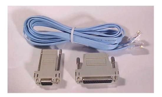
Este cable se llama transpuesto (rollover), porque los pines en un extremo del cable se invierten en el otro, como si un extremo del cable se hubiera rotado o girado. En la última práctica de laboratorio, cuando fabricamos el jumper de conexión directa (straight through), si hubiéramos colocado el
