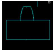
Quitamos la parte del rectángulo de abajo que no nos sirve posteriormente por medio de un arreglo polar copiamos (N) veces el diente para ponerlos al ras del contorno de cada uno de los engranes. Posteriormente nos ponemos a detallar cada uno de los interiores de estos engranes:
