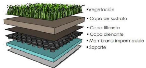
Figura 1. Esquema de los componentes de un sistema típico de naturación en cubiertas. Imagen de García, Ilse (2010). Reproducción realizada con fines didácticos.
