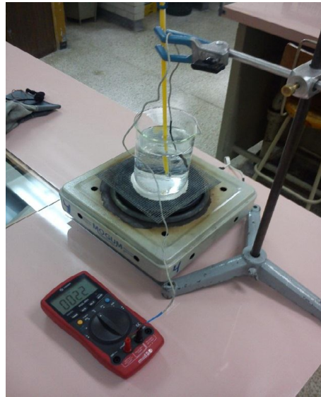
Figura 5: Fotografía donde se muestra un termómetro de mercurio y un termopar conectado con un multímetro.
