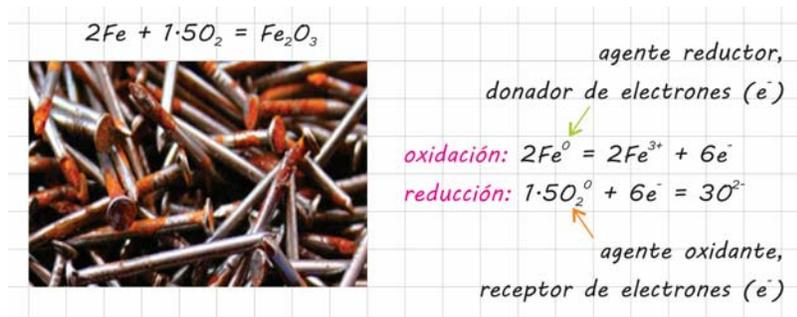
Figura 1.6. La oxidación de un clavo de hierro en contacto con el oxígeno atmosférico produce hematita, un óxido de hierro de color típicamente rojizo, en el cual Fe está presente en su estado oxidado (valencia +3), mientras que el oxígeno se encuentra en su estado reducido (valencia -2).
