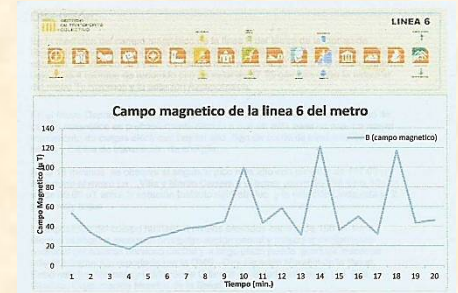
Figura 5.3 Variación del campo magnético en la línea 6 del tren subterráneo de la Ciudad de México.
