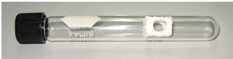
Figura 4. Tubo de depósito de la muestra, con las marcas en ambos lados se busca minimizar la variación en las lecturas, por efecto de la diferencia de grosor de las paredes del tubo.
