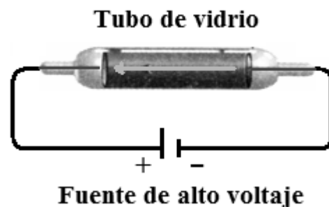
Fig. 4.1 Dispositivo eléctrico para producir descargas eléctricas en gases, conocido como tubo de rayos catódicos.
